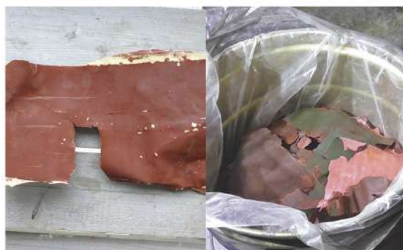
剥離した塗膜片(廃棄物)
